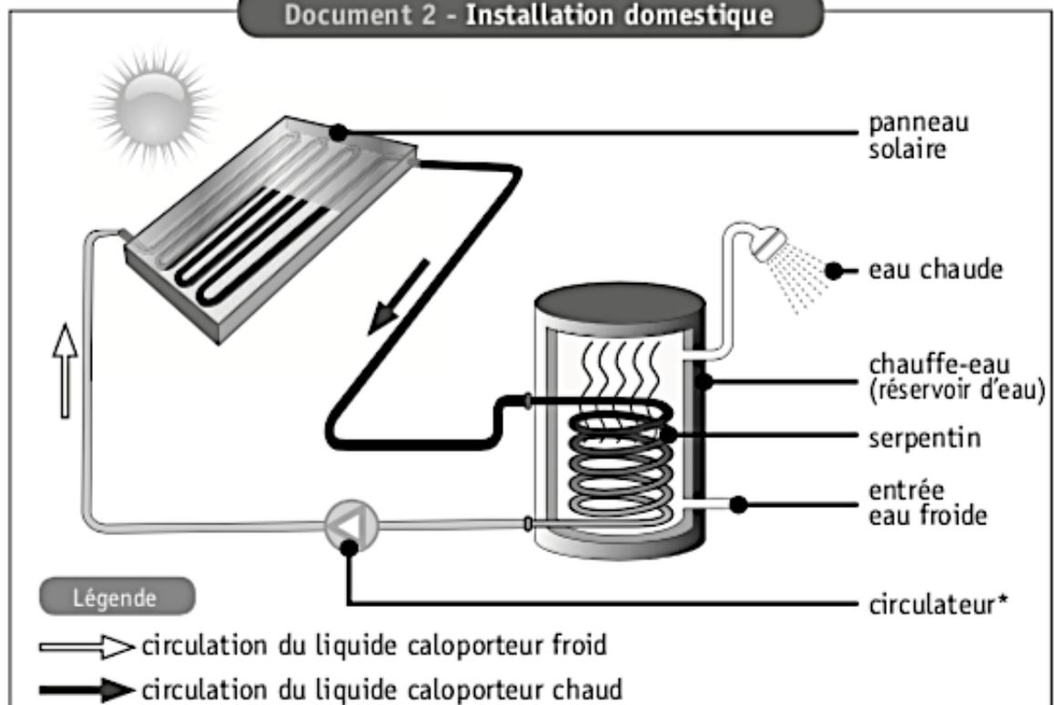
\* Circulateur : pompe électrique qui permet le déplacement du liquide caloporteur.
