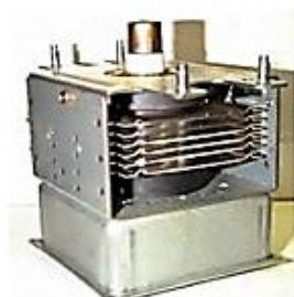
Le magnétron d'un four à micro-ondes fabrique des ondes de forte puissance
