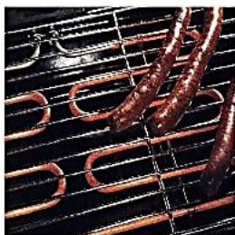
Une résistance de barbecue électrique qui rougit
